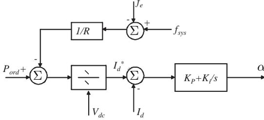
Fig. 4. Control loop for HVDC rectifier.
